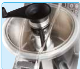
Coperchio trasparente con raschiatore/emulsionatore
